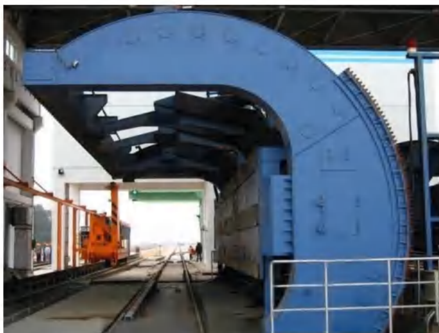
图 3.2-4 翻车机设施示意图
