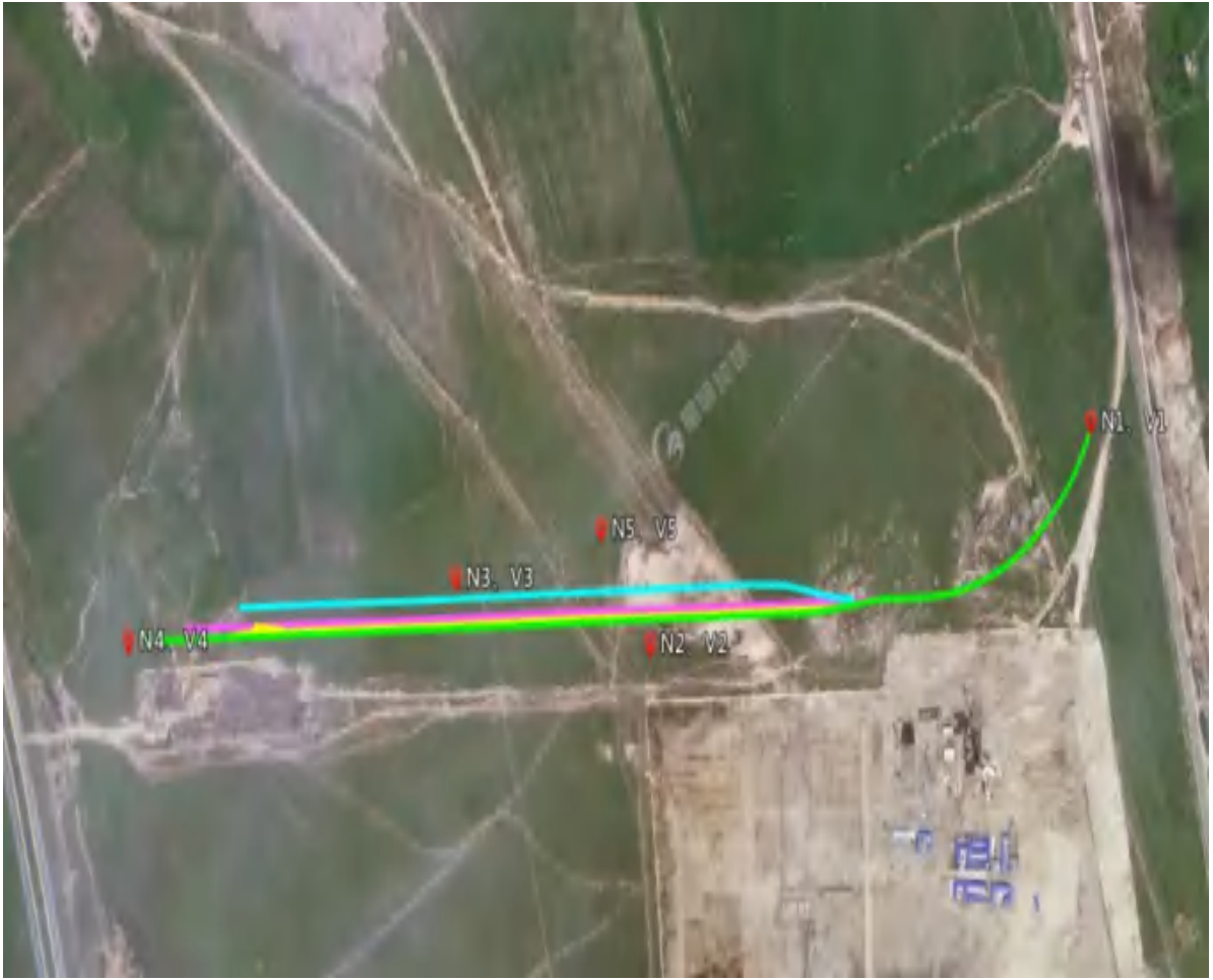
图 4.3-12 本项目铁路线两侧声环境及振动环境现状监测点位分布图
