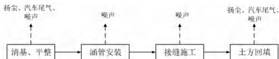
图3.2-7 涵管桥施工工艺流程及排污节点图
